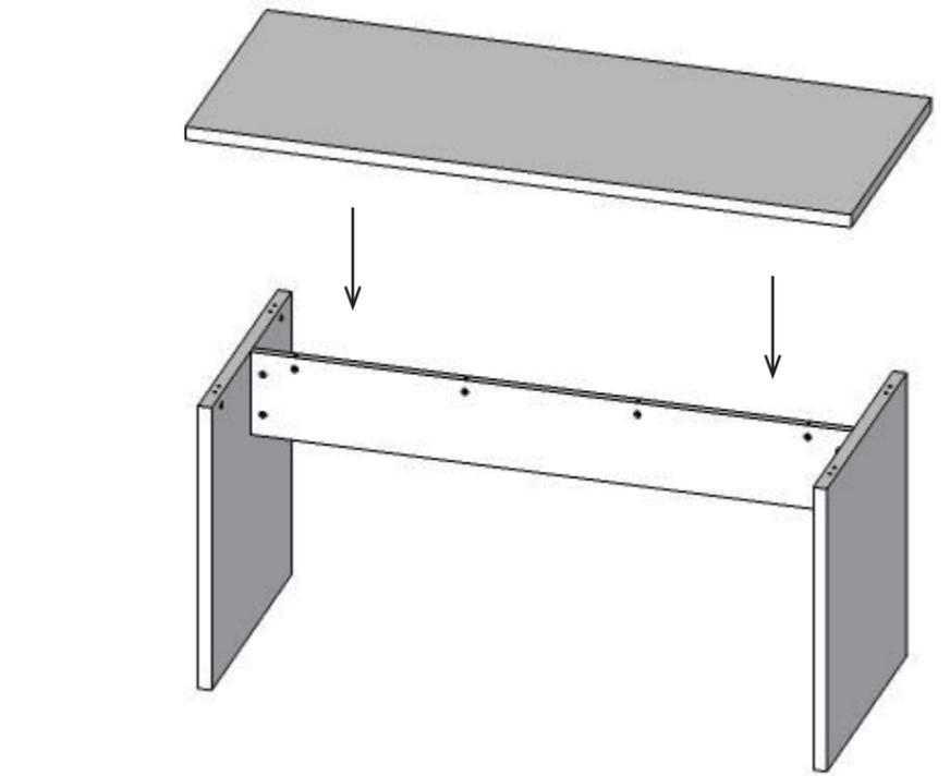
天板をカムロック用および木ダボ用穴に合わせて挿入します
